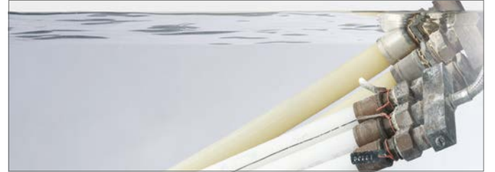
Şek. 3-4 Ömür testindeki borular (su teknesinde basınç altında)
