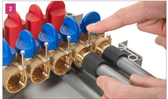
Şek. 7-8 Emniyet pimini işitilebilir klik sesi ile kilitlenene kadar aşağı bastırın
