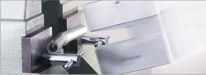
Şek. 3-2 RAUTTAN flex üniversal boru, çentik darbe test cihazında
