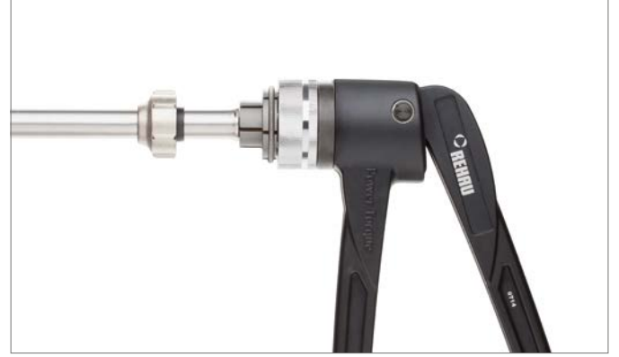
Şek. 16-3 Boru ucunu bir defa genişletin
