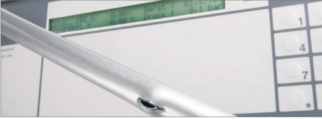
Şek. 3-1 RAUTTAN flex üniversal boru ile yapılan bir patlatma basınç testinin sonucu
